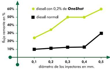
El test **Peugeot XUD 9** estima la eficacia de un aditivo para reducir la formación de depósitos, a través del flujo remanente de combustible, en porcentaje, a su paso por el inyector. Los fabricantes de motores franceses exigen un flujo remanente mínimo del 15% para inyectores de 0,1 mm de diámetro.
